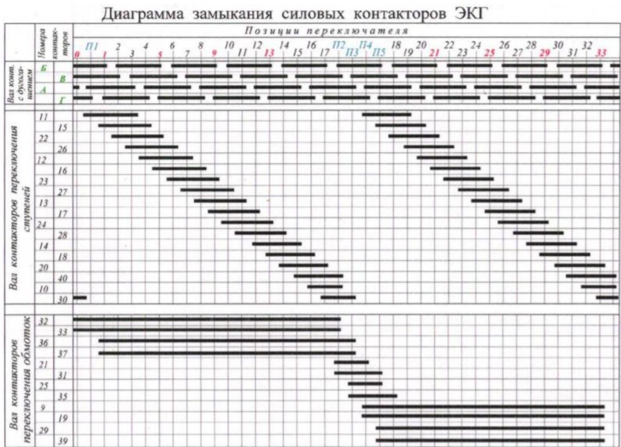
Рисунок 1 – Диаграмма замыкания силовых контакторов ЭКГ
